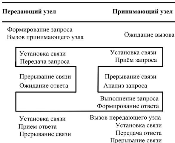
Рис. 4.10. Схема взаимодействия удаленных узлов
