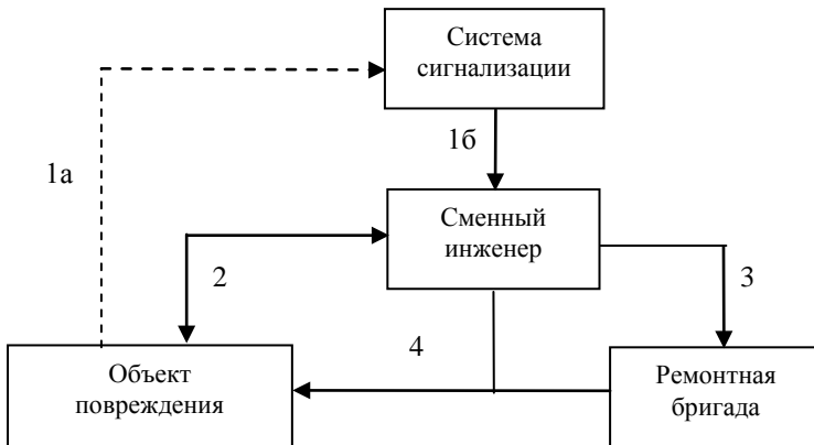
Рис. 4.8. Схема бизнес-процесса обнаружения и устранения повреждений в технологической сети ООО «Самаратрансгаз»
